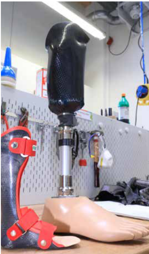
Carbonorthese mit Rekordgewicht von nur 71 Gramm, rechts Prothese aus Verschnittresten des A380.
